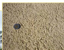
Stabilisé avec liant « STARMINE »
